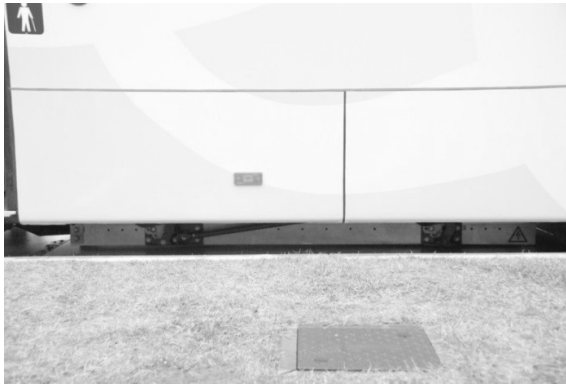
Rys. 11. Pickup (pad ładujący) zamontowany w autobusie Solaris Urbino 12 electric (E12) w barwach projektu „Emil”
