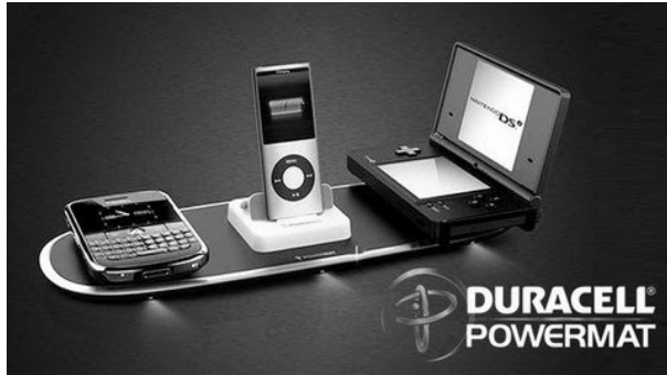
Rys. 2. Mata do bezprzewodowego ładowania sprzętów elektronicznych (źródło: http://www.pcworld.pl/news/394867/Jak.to.dziala.i.kto.rozwija.standardy.bezprzewodowego.ladowania.html ; dostęp 26.10.2014)
