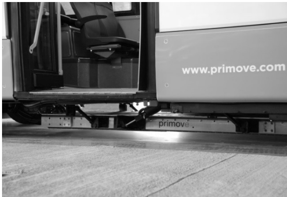
Rys. 8. Tzw. Pickup (pad ładujący) za pomocą którego dokonywano próbnych operacji ładowania (źródło: http://www.verkehr-bs.de/ ; dostęp 26.10.2014)
