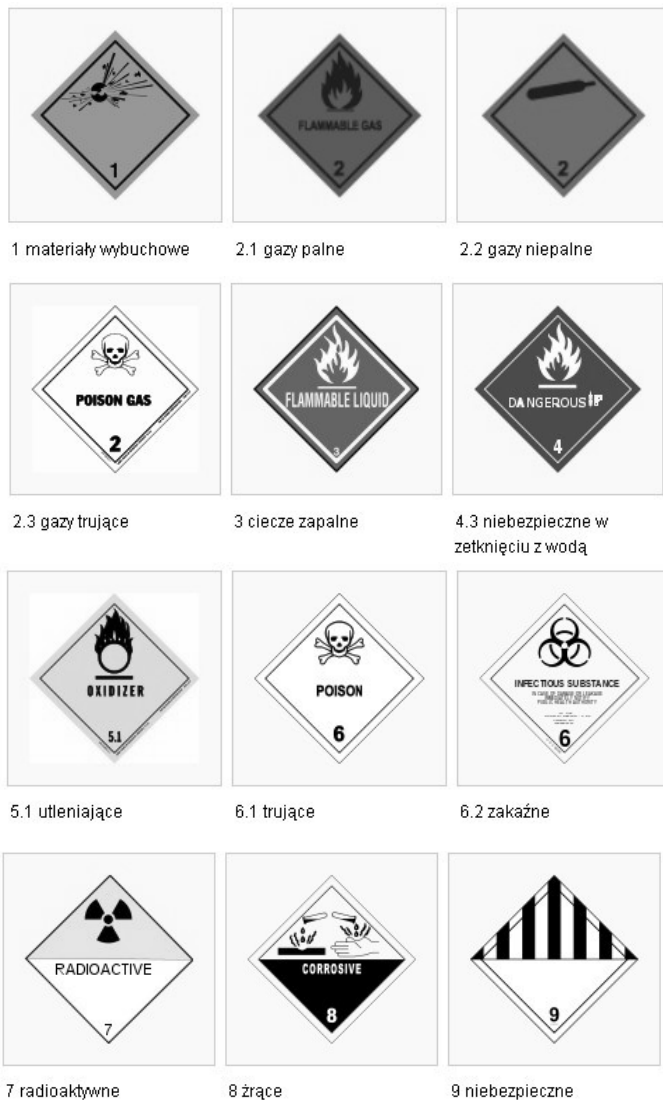
Rys. 1. Przykładowe nalepki na towary niebezpieczne (źródło: Grzegorzycyk K., Hancyk B., Buchar R., Towary niebezpieczne w transporcie drogowym ADR 2007 – 2009, Wydawnictwo Buch-Car, Błonie 2007 r.)
